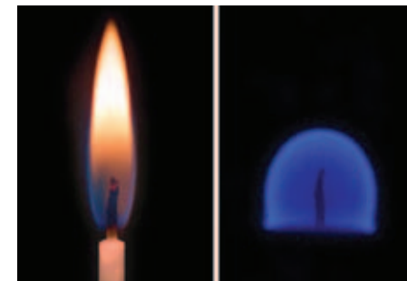
Пламя свечи при наличии гравитации (слева) и в состоянии невесомости (справа). В невесомости движение воздуха отсутствует, поэтому, во-первых, частички сажи не поднимаются и пламя принимает сферическую форму, а во-вторых, пламя слабее охлаждается, стеарин сильно разогревается и выделяет водород, который горит голубым пламенем.
