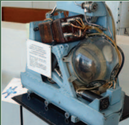
Катапультируемая тележка для спасения собак при полетах на ракетах
